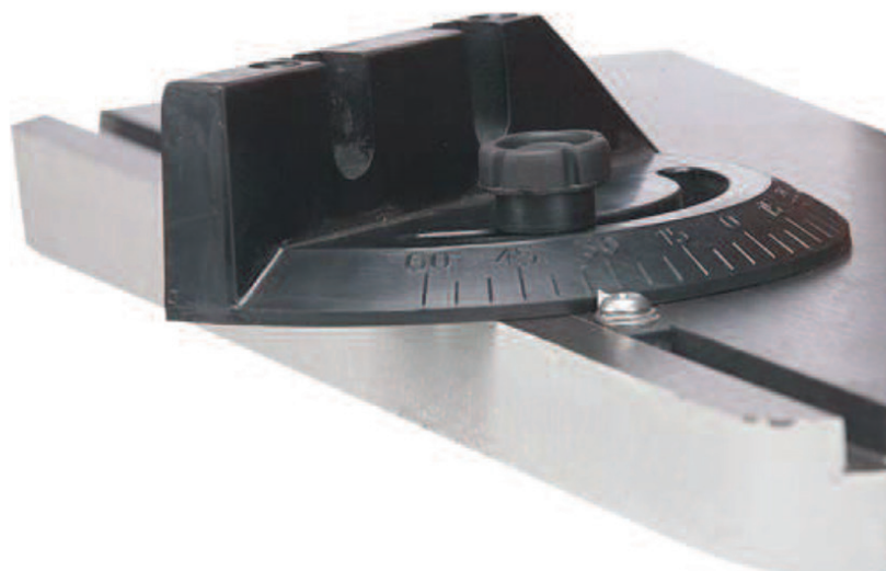
Szlifierka wyposażona jest w linijkę kątową z podziałką, prowadzoną w rowku stołu.
